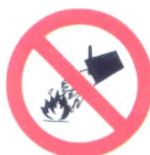
Verboden met water te blussen
